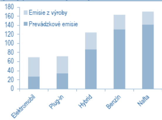
Odhad produkcie CO 2 v gramoch na kilometer jazdy pri 250 tis. najazdených km
